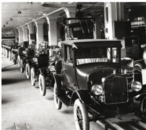
Cadena de montaje del Ford T, el primer coche de la historia fabricado en serie. La segunda Revolución Industrial se caracteriza, entre otros rasgos, por una nueva organización del trabajo orientada a la disminución de los costes y el incremento racional de la productividad.
